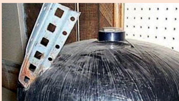
Versagensursachen von gewickelten CFK-Druckbehältern nach mechanischen Beschädigungen (Stöße, externer Abrieb, Stürze, Impact) (1)
