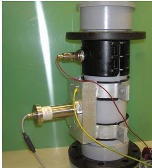
Abb. 3 Mikrowellen-TS-Sensor MWTS PP tube TK inkl. Rohrstück
