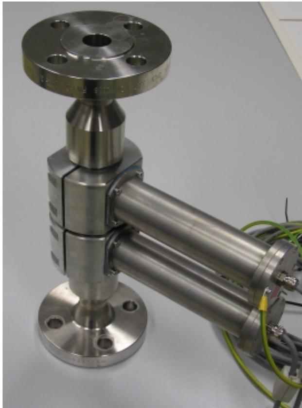
Abb. 10 Mikrowellen TS-Messzelle für kombinierte Reflexions-/Transmissionsmessung
