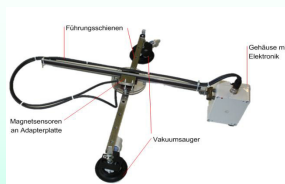
Aufbau des Handscanners. Drahtlose Verbindung zu Laptop als Bedienkonsole.
