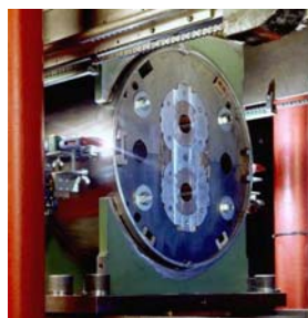
Supraleitende Dipole für den LHC Beschleuniger, CERN, Genf
