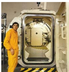
Personenschleuse-Vorbereitung der Dichtfläche zur Dichtheitsprüfung
