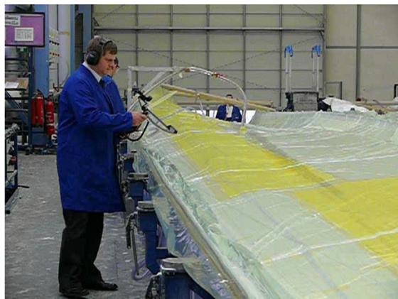
Dichtheitsprüfung an Windkraftträdern
