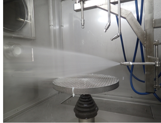
Strahlbild einer Flachstrahldüse zur Prüfung gemäß IP X9K
