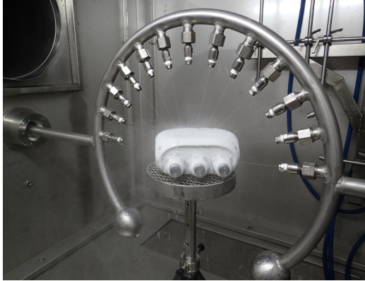
Vorrichtung zur Prüfung gemäß IP X4 unter Einsatz eines Schwenkrohrs
