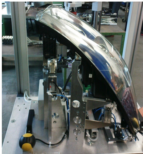
Dichtheitsprüfstand für Scheinwerfer
