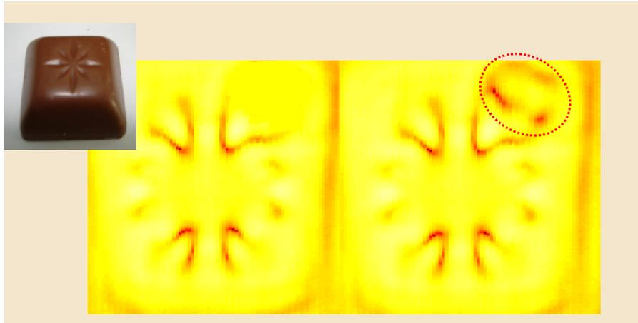
**Messungen bei 260 GHz in Transmission
