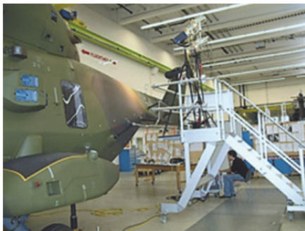
Abb.20 OLT Prüfung einer CFK HC-Struktur
