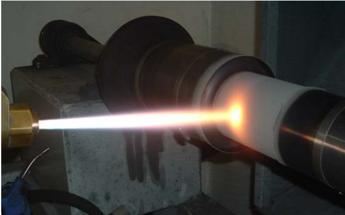
Abbildung 1: Beschichtung einer Profiwalze mit Hilfe des thermischen Spritzens
