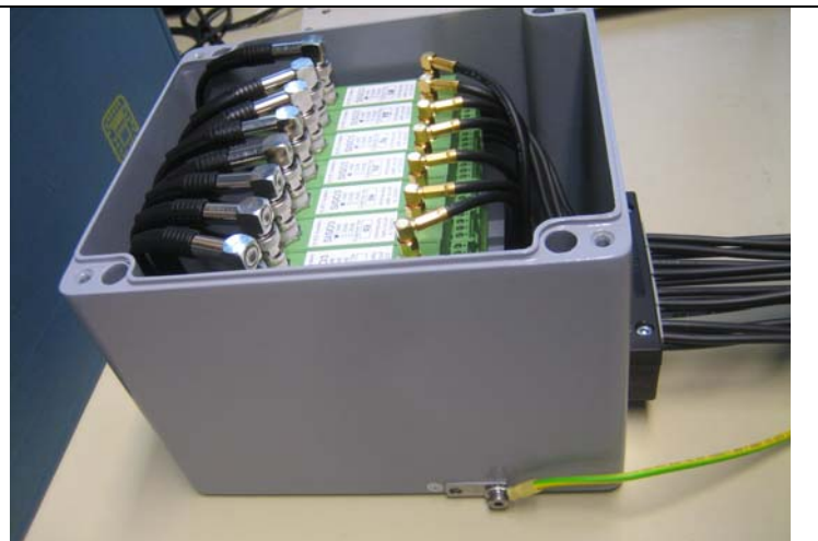
Bild 6 – HISO3 offen, Seitenansicht, vorne unten Erdanschluss
