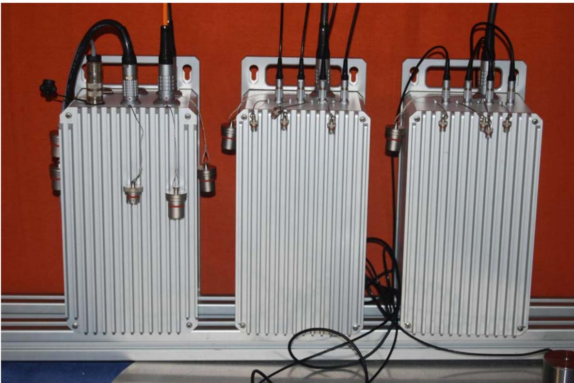
**Abb. 1** SINUS.AE.net ( 1xAE.switch + 2xAE.engine = 8 Kanäle a 2MHz )
