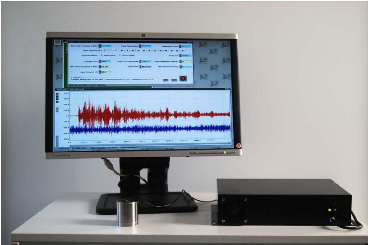
**Abb. 2** BeRT.AE.net (16 Kanäle a 1MHz oder 8 Kanäle a 2 MHz oder 4 Kanäle a 8 MHz)
