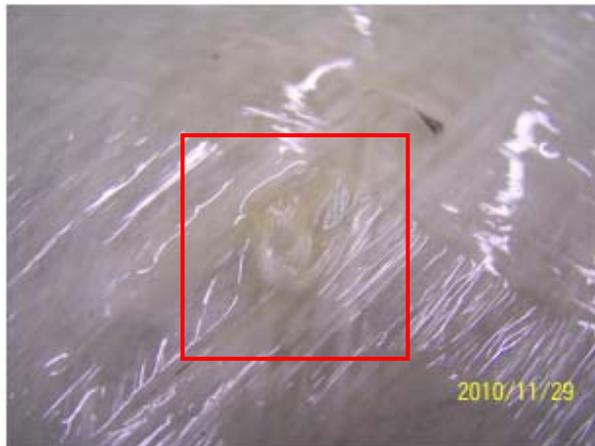
**Bild 1:** Knoten in der Glasfaserschicht
