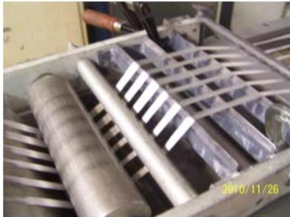
**Bild 2:** Glasfasern werden über drei scharfe Kanten gezogen
