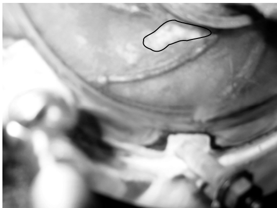
Bild 6a. Die geschlossene Kurve markiert den Dampfblasenschwarm der entwickelten Kavitation in einem Laufschaufelkanal.
