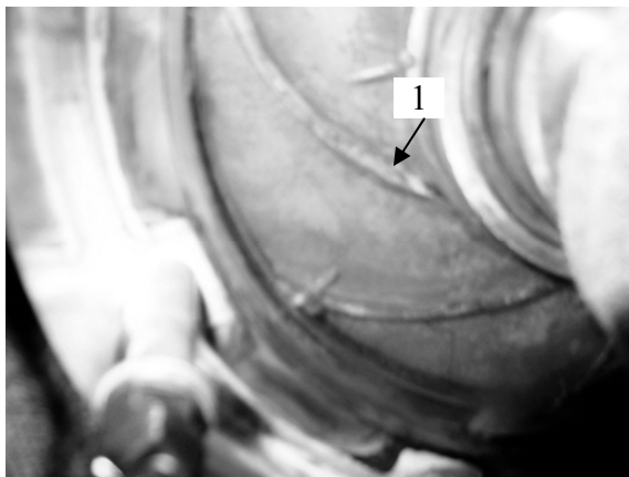
Bild 5a. Blick in die Kreiselpumpe durch das transparente Gehäuse kurz vor der saugseitigen Drosselung. Markierung 1 zeigt eine der sieben rückwärtsgekrümmten Schaufeln des Pumpenlaufrades.
