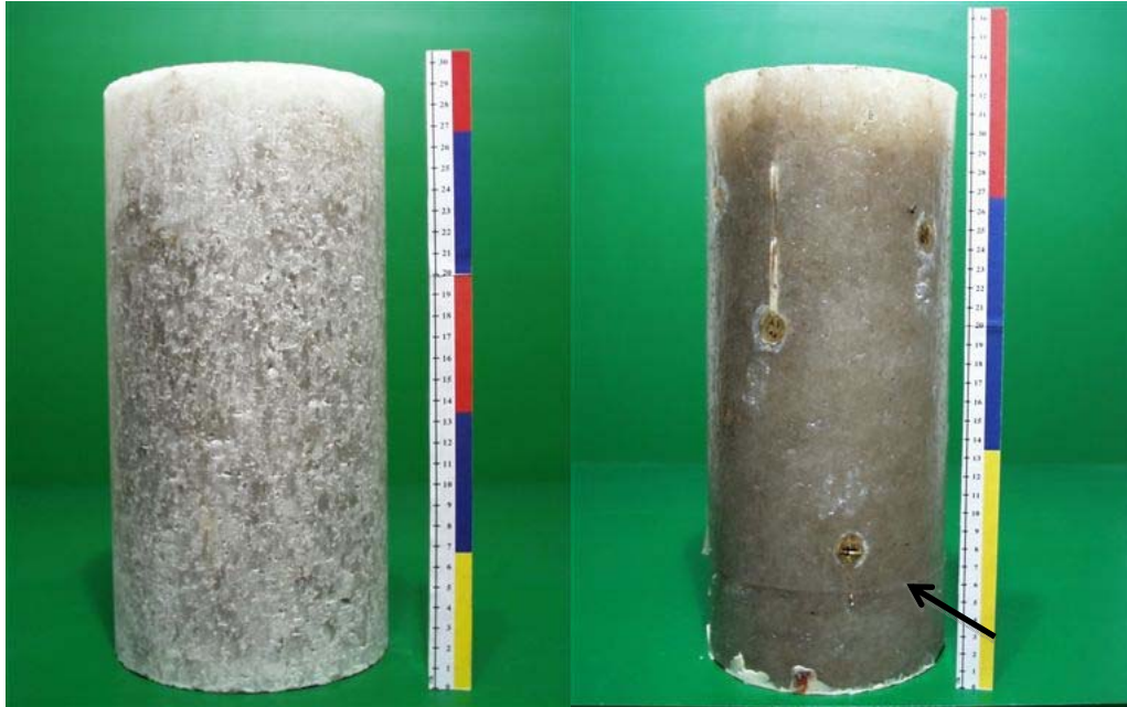
Abbildung 7: Foto der zylindrischen Steinsalzprobe ASSE 228 vor dem Extensionsversuch (linkes Teilbild) und nach dem Extensionsversuch (rechtes Teilbild).
