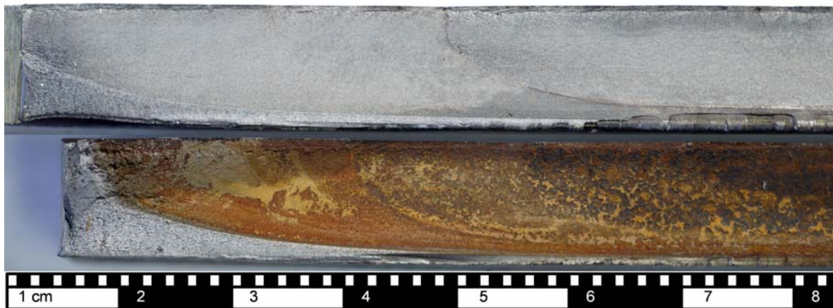
Abbildung 3: Oben: Teilstück der Bruchfläche des nicht korrodierten Risses; unten: der Bruchfläche des korrodierten Risses
