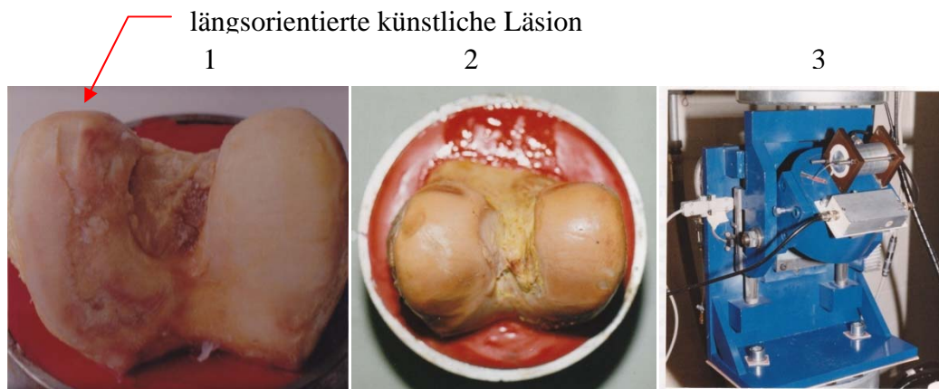
Abb. 3: Explantierte Gelenkköpfe mit der Prüfvorrichtung (1- Femurkondylen mit künstlicher Läsion; 2- tierische Kondylen ohne Schaden; 3- Prüfeinrichtung)
