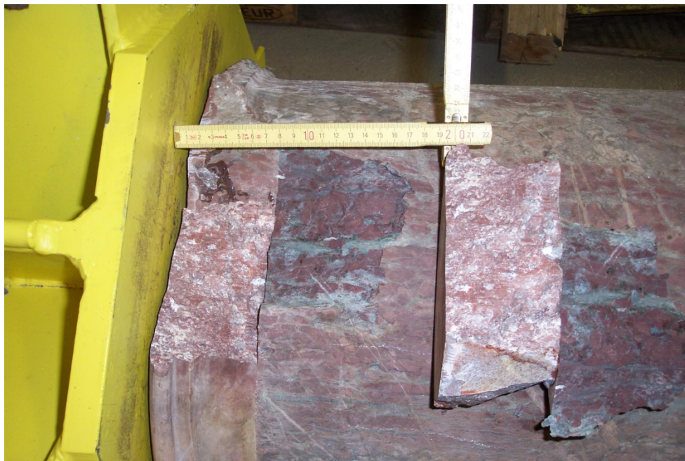
Abbildung 4 Abgesprengte Vierung nach exzentrischer Belastung
