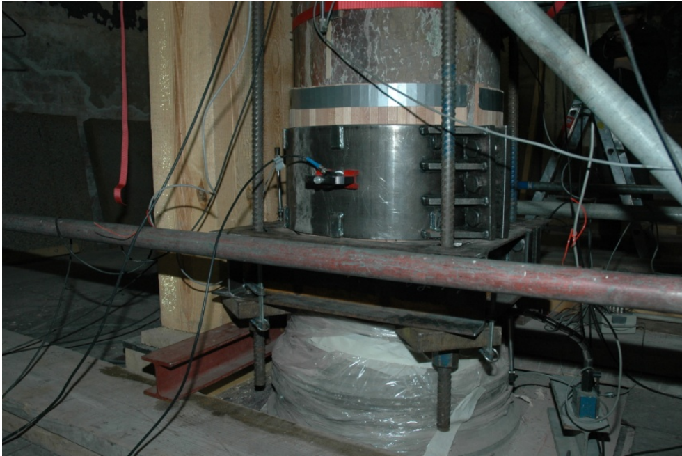
Abbildung 5 Kontrollsensor Ch14 an der unteren Manschette
