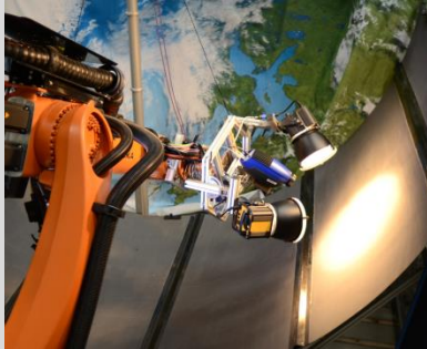
Abb. 1: Thermografie Endeffektor im Einsatz am Roboter bei der produktionsintegrierten QS
