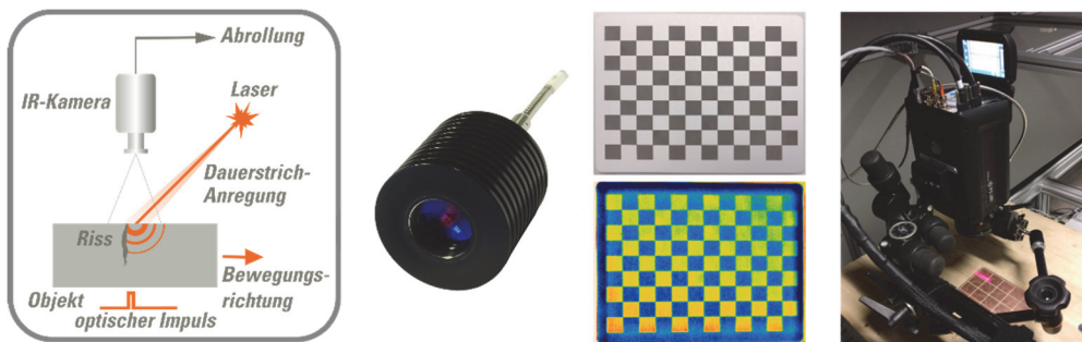
Abb. 4. V.l.n.r.: Prinzip der Online-Thermografie, Linien-Optik, IR-Kalibriertarget, Verfahrtisch mit IR-Kamera und Laserlinie.
