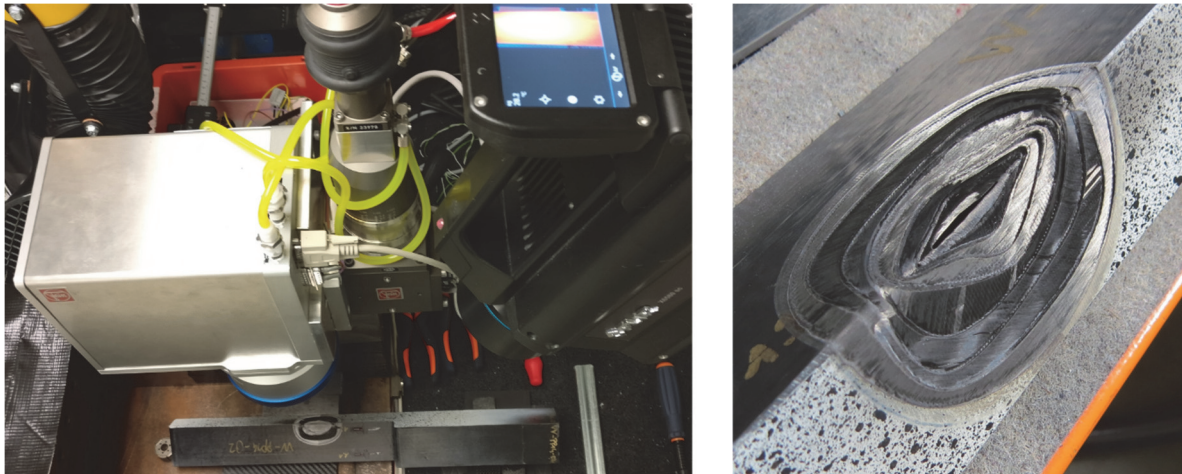
Abb. 13. Laser-bearbeitung- und Flying-Spot-Thermografie an Impactgeschädigtem CFK-Demonstratorbauteil (links), Bauteil nach lagenweisem faserorientierungsoptimiertem Abtrag des geschädigten Bereiches.
