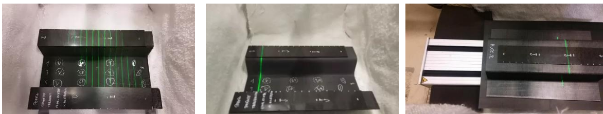
Abb. 6: Defektprobe im Laserthermografie-Versuchsaufbau mit eingeschaltetem Laserpointer, Variante 1: Flächenanregung (links), Variante 2: Linienanregung bei ruhendem Objekt (mitte) und Variante 3: Linienanregung bei bewegtem Objekt (rechts)
