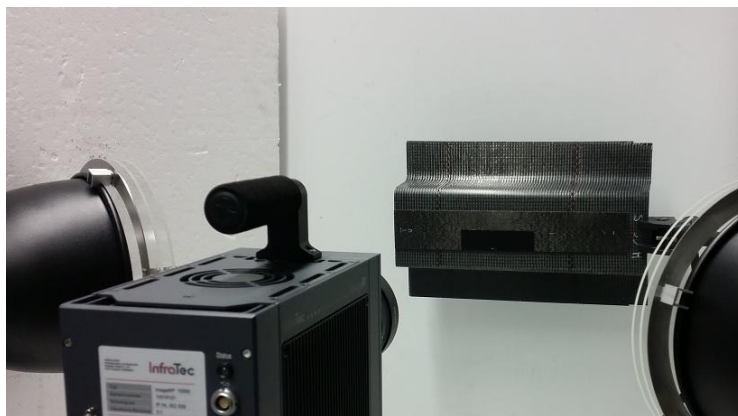
Abb. 2: Laboraufbau mit Defektprobe, Thermografiekamera (Auflösung 1920 x 1536 Pixel) und Halogenstrahlern 2x 2 kW
