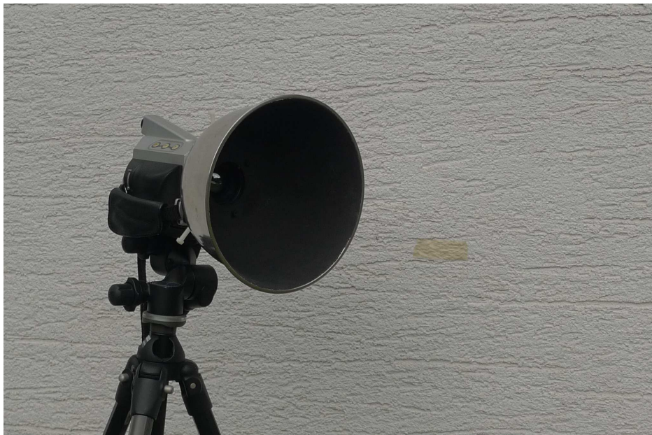
Abb. 1: Testaufbau zum Einmessen des Emissionskoeffizienten, bestehend aus Prüffläche (hier Rauputz), Vergleichsstreifen und temperierter Haube, die auf ca. 50 °C aufgeheizt wird.
